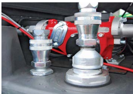
Kit di attacchi rapidi per collegamento a gruppi elettrogeni (tubo di aspirazione + attacchi rapidi di alimentazione e ritorno da 1/2"). n. 2 rapid couplings, size 1/2", for generator sets connection (feeding + return line+ suction pipe).
