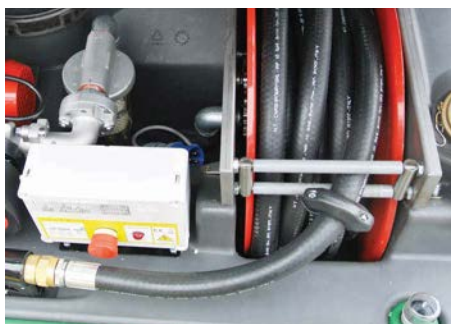
Il quadro elettrico e l'arrotolatore. Electric switchboard and spring rewind hose reel.
